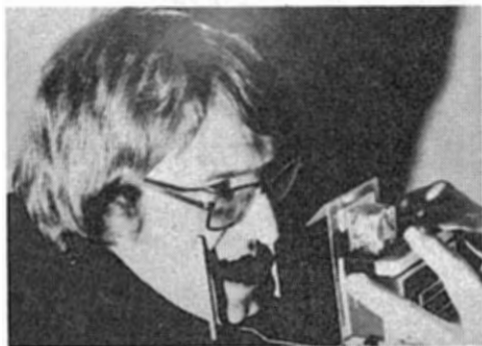
KODAK INSTATECH Kamera påmontert nærlinse og stang med u-ramme, for fotografering på 15 cm.
